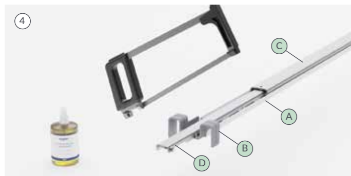
4. Taglia la copertura del drenaggio simmetricamente da entrambe le estremità, mantenendo la stessa lunghezza della parte tagliata del canale di drenaggio; questo dovrebbe comportare una lunghezza della copertura inferiore di 28 mm rispetto al canale tagliato. A - Pezzo guida per l'installazione (per uso temporaneo) B - Cutter per il canale di drenaggio della doccia, griglia e guide C - Canale di drenaggio della doccia D - Griglia
