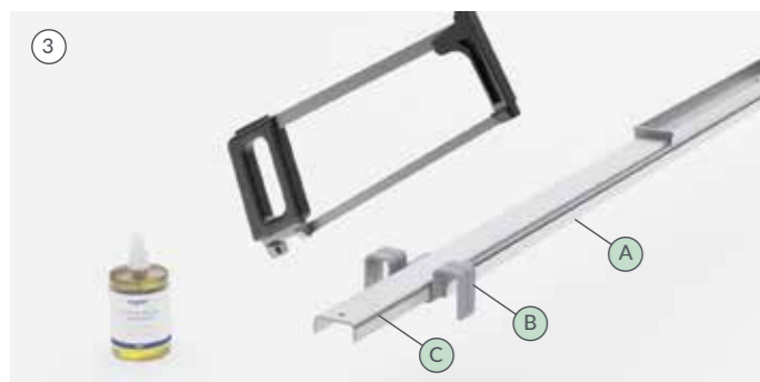
3. Taglia il canale di drenaggio della doccia alla lunghezza L, mantenendo una distanza simmetrica da entrambe le estremità del canale utilizzando il cutter incluso, le lame di sega in acciaio inox e il lubrificante per il taglio (che deve essere applicato più volte durante un taglio completo). A - Pezzo guida per l'installazione (per uso temporaneo) B - Cutter o canale di drenaggio della doccia, griglia e guide C - Canale di drenaggio della doccia
