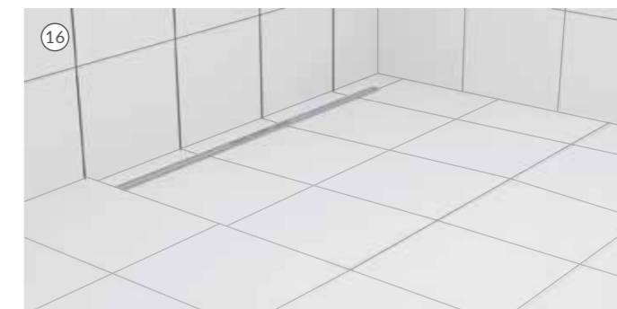
16. Lascia agire per il tempo minimo raccomandato dal produttore (1,5 ore solo per il WIPER Tanking Kit) e procedi con il lavoro di piastrellatura.
