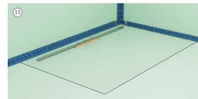
15. Installa il rivestimento impermeabilizzante completo della cabina doccia, secondo il sistema selezionato, ad esempio il kit Wiper Tanking Kit raccomandato. Subito dopo aver applicato la membrana impermeabilizzante liquida attorno alla base del drenaggio, posiziona il drenaggio nella sua posizione finale sulla base.
