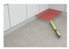
Per calcolare il livello della superficie del piatto doccia completato nel punto in cui si colloca la canalina doccia, è essenziale considerare attentamente la pendenza della lastra con una pellicola isolante liquida.
