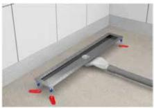
2. Montare i piedini di regolazione sulla canalina doccia avvitandoli saldamente. Collegare lo scarico al sistema fognario e posizionare la canalina in modo che il bordo superiore sia circa 1 mm al di sotto del livello del pavimento. Fissare i piedini al pavimento. Si consiglia di lasciare la pellicola protettiva sulla fascia finché non viene inserita nella canalina.
